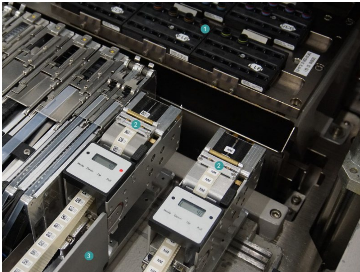
Рис. 15. Питатель для подачи этикеток в действии
